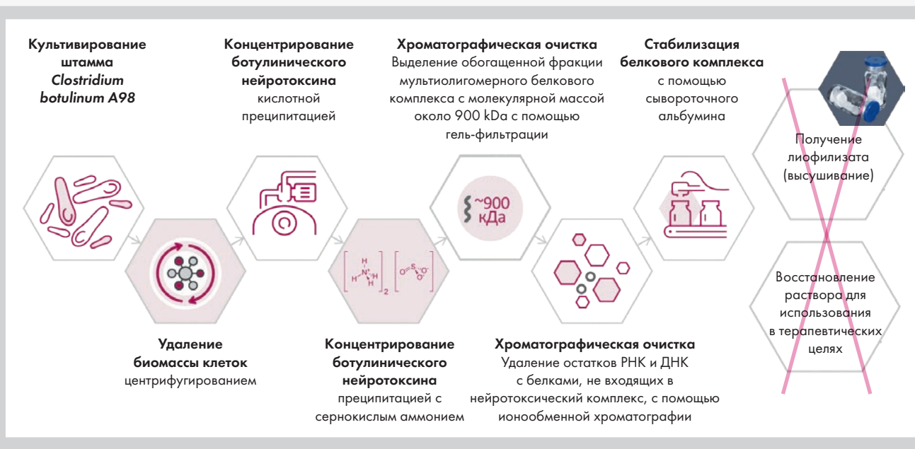
Рис. 1. Технология производства препарата Миотокс®
